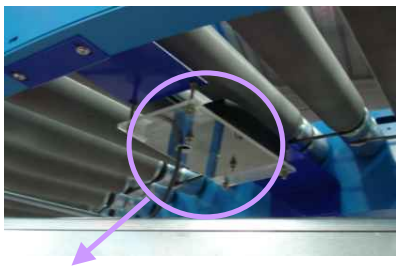
RFID 리더에 의해 시스템이 버 킷의 일련번호를 인식하며 보관 위치를 결정하고 목적지까지 버 킷을 자동으로 Routing함
