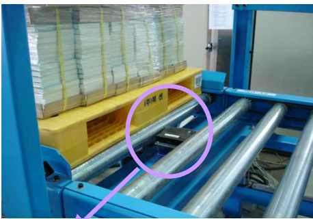
RFID 리더에 의해 시스템이 팔레트의 일련번호를 인식하며 보관위치를 결정하고 목적지까지 팔레트를 자동으로 Routing함
